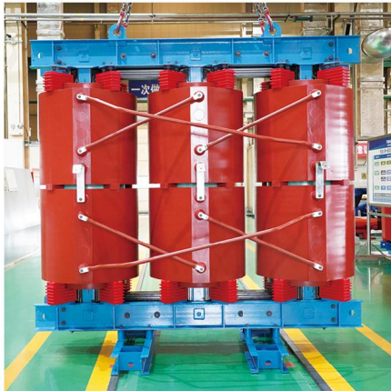
ZQSCB-4000/35/1.18/1.18 牵引整流变压器，用于天津地铁、杭州地铁、南京地铁、大连地铁、洛阳地铁等项目，采用双绕组双分裂结构，产品过载能力强，满足重牵引VI类负荷过载要求，安全性能好。
